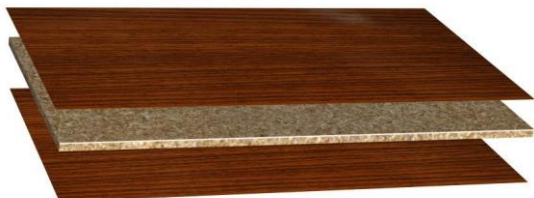
Рисунок 21 ДСП и меламин отдельно (БМ)
